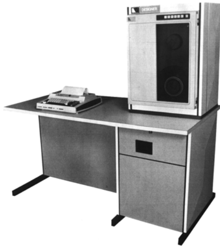
Figura 1 – Sistema monoposto ComputerVision CGP que foi instalado na Setenave em 1977. Foi o primeiro sistema CAD/CAM instalado em Portugal, baseado num minicomputador.
