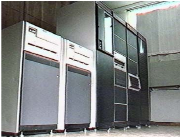
Figura 7 – Iberomoldes: sistema PDP 11/70 e unidades de disco (em primeiro plano).
