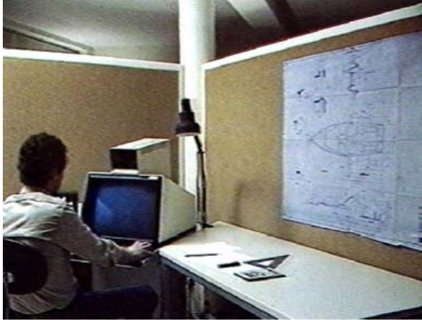
Figura 9 – Terminal gráfico Tektronix 4014 (vectorial e monocromático), com teclado adicional (o chamado PKF) e o monitor não gráfico (para mensagens e interface com o utilizador). Na foto, Eng. Emanuel Ramalhão, um dos responsáveis pelo grupo de CAD/CAM.
